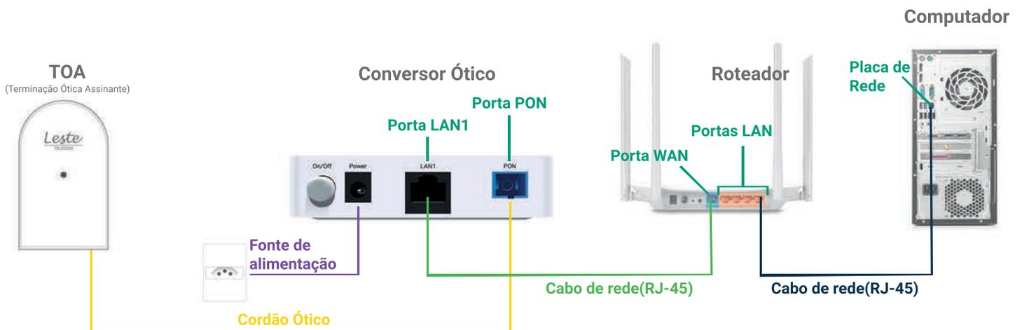
Se o conversor óptico estiver conectado ao seu computador, desconecte a ponta deste cabo e conecte a mesma ponta na **Porta WAN** do seu roteador.
